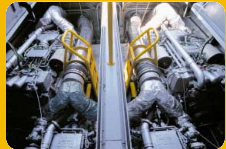
Insgesamt 8 K36.5 Turbolader setzen hier 4 MTU Motoren unter Druck.
